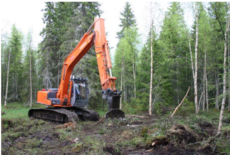
Kuva 4.1.1.2. Kaivinkoneella voidaan tehdä kasvupaikkakohtaista muokkauksen jälkeä. Ohutkuntaiset kohteet on mahdollista laikuttaa. Kuva Lauri Karvonen.
